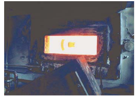
Bild 7: Flachflammenbrenner im FLOX®-Betrieb Fig. 7: Flat flame burner in FLOX® mode
