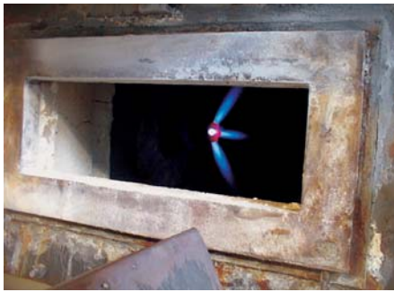
Bild 6: Flachflammenbrenner im Flammenbetrieb Fig. 6: Flat flame burner in flame mode
