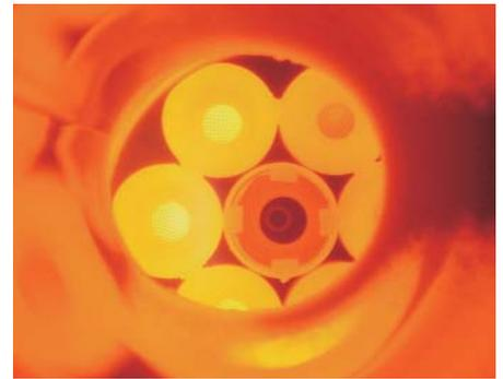
**Bild 7:** Regenerativbrenner im Doppel-P-Rohr
